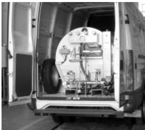
Vista serbatoio CO 2 installato sul veicolo adibito a rifornimento mini-bulk
